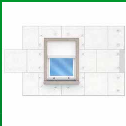
Points de renfort en pose calé-chevillé.
