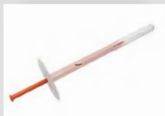
Cheville à expansion à frapper pour isolant PSE de 40 à 160 mm
