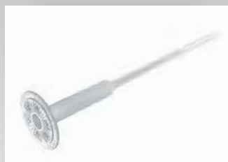
Cheville à expansion à visser pour isolant PSE ou laine de roche de 60 à 240 mm
