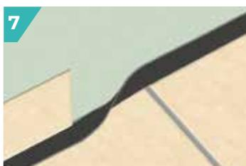
7 Replier **COLLIBANDE** sur le carreau et coller les plinthes sur le retour.
