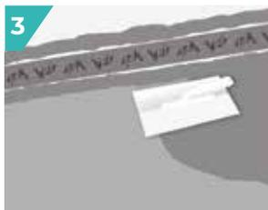
**3** Après 4 h, appliquer 1,5 kg/m<sup>2</sup> de **FLEXÉTANCHE ULTRA** sur la surface courante, à la lisseuse inox.
