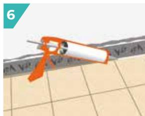
**6** Le lendemain, combler les vides périphériques et les joints de butée à l'aide d'un mastic assurant l'étanchéité.
