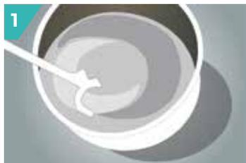
Gâcher **COLLIFLEX PREMIUM 2** au malaxeur électrique avec **6,75 à 7,25 L** d'eau par sac de 25 kg.
