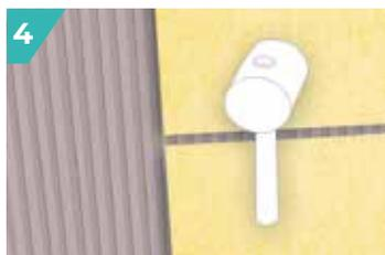
Poser les carreaux sur les sillons et les battre pour assurer un transfert optimal de la colle, en ménageant une largeur de joint de 4 mm minimum augmentée de la tolérance du carreau (6 mm pour les plaquettes de terre cuite).
