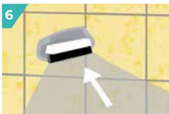
Étaler et faire pénétrer **JOINT SOUPLE UNIVERSEL** ou **JOINT FIN PREMIUM** en diagonale avec une raclette ou une taloche caoutchouc.
