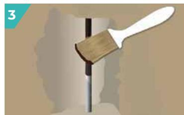
3 Si les aciers ne sont pas recouverts immédiatement, appliquer **RÉPAFER** ou **PASSIFER** afin d'éviter le développement de corrosion.
