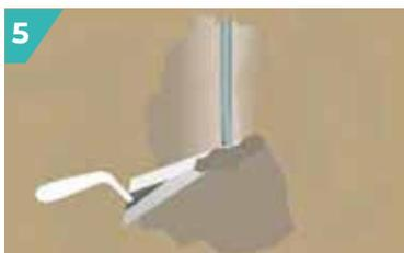
5 Gâcher le mortier de réparation retenu et appliquer à la truelle en serrant fortement.
